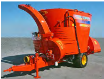
Узел бросателя соломы "Vulcan System" Серия TIGER (13-16-20-24 м³)
