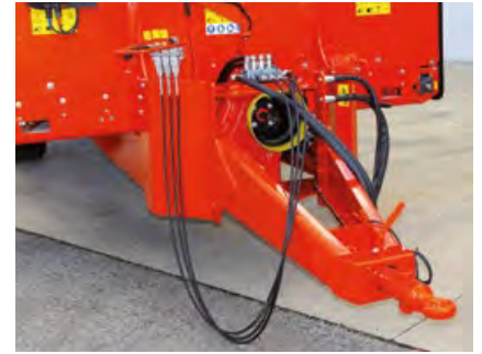
Органы управления при помощи распределителя, соединенного кабелем Серия BUFFALO V2
