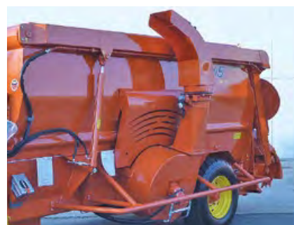
Узел бросателя соломы "Vulcan System" для серии SAMURAI 5
