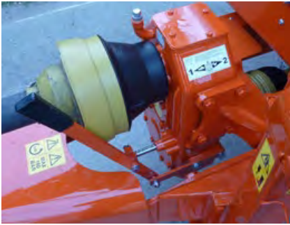
Переключение скорости с 2 скоростями для понижения потребления мощности и ускорения разгрузки
