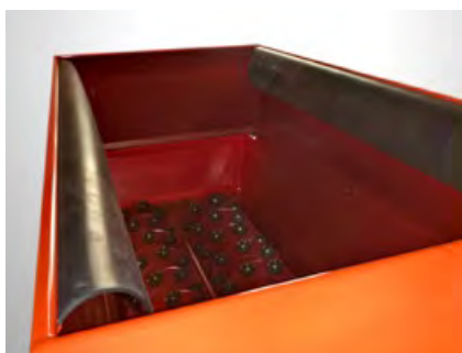
Система распыления из оцинкованных труб установлена по верхнему периметру
