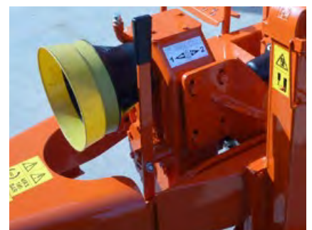
Переключение скорости с 2 скоростями для понижения потребления мощности для серии 450-500
