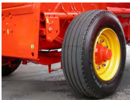
Ось с рессорными амортизаторами и механическими тормозами для неровных дорог.
