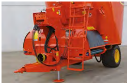
Серия TIGER • Независимая гидравлическая установка • Органы управления при помощи распределителя с кабелями • Гидравлическая ножка
