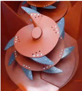
Шнек с комплектом из 3 дополнительных ножей для большего увеличения резки
