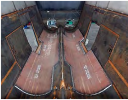
Накладка на дне ванны из стали Hardox
