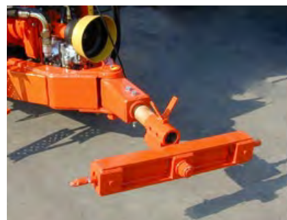
Складной руль для повышения маневренности в узких проходах
